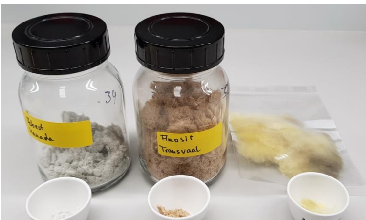
Abbildung 4: Vorbereitung für die Kontamination einer Feuerwehrjacke
