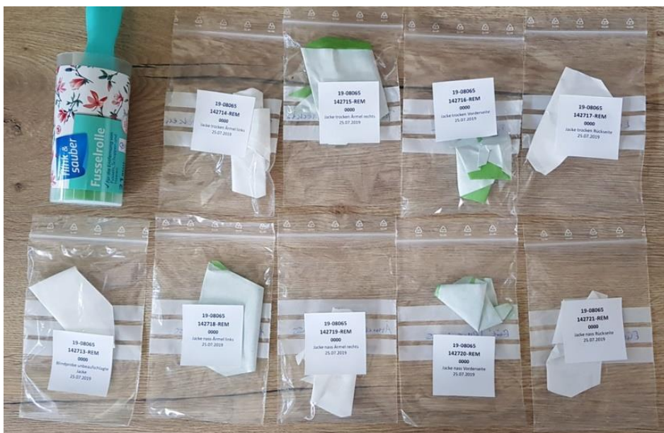
Abbildung 6: Blindprobe und je 4 Klebepapiere der Probenahmen trocken und nass
