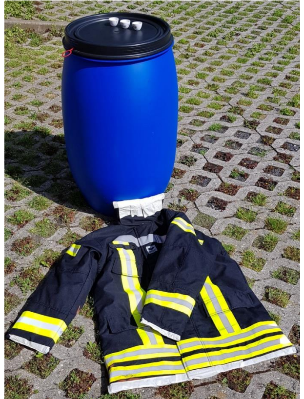
Abbildung 5: Versuchsanordnung für die Beaufschlagung der Testjacke mit Asbest und KMF
