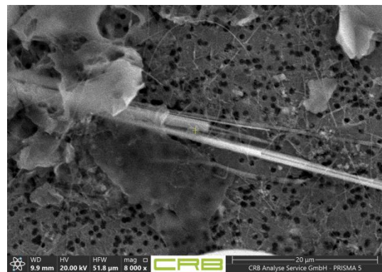
Abb 10: Filterpräparat Ärmel links trocken - Amosit
